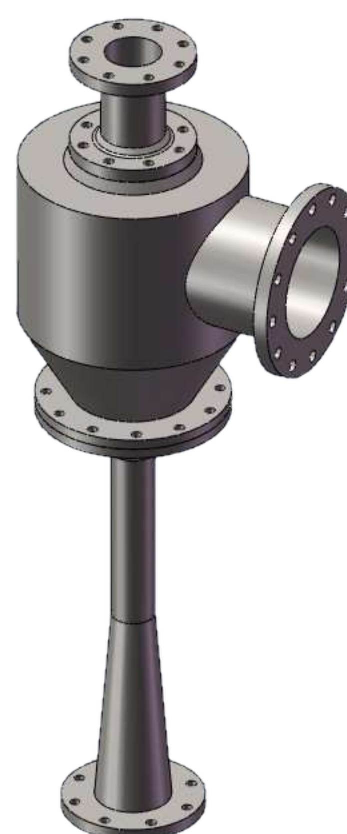
Насос для экстракции пароводяной смеси, создатель вакуума
