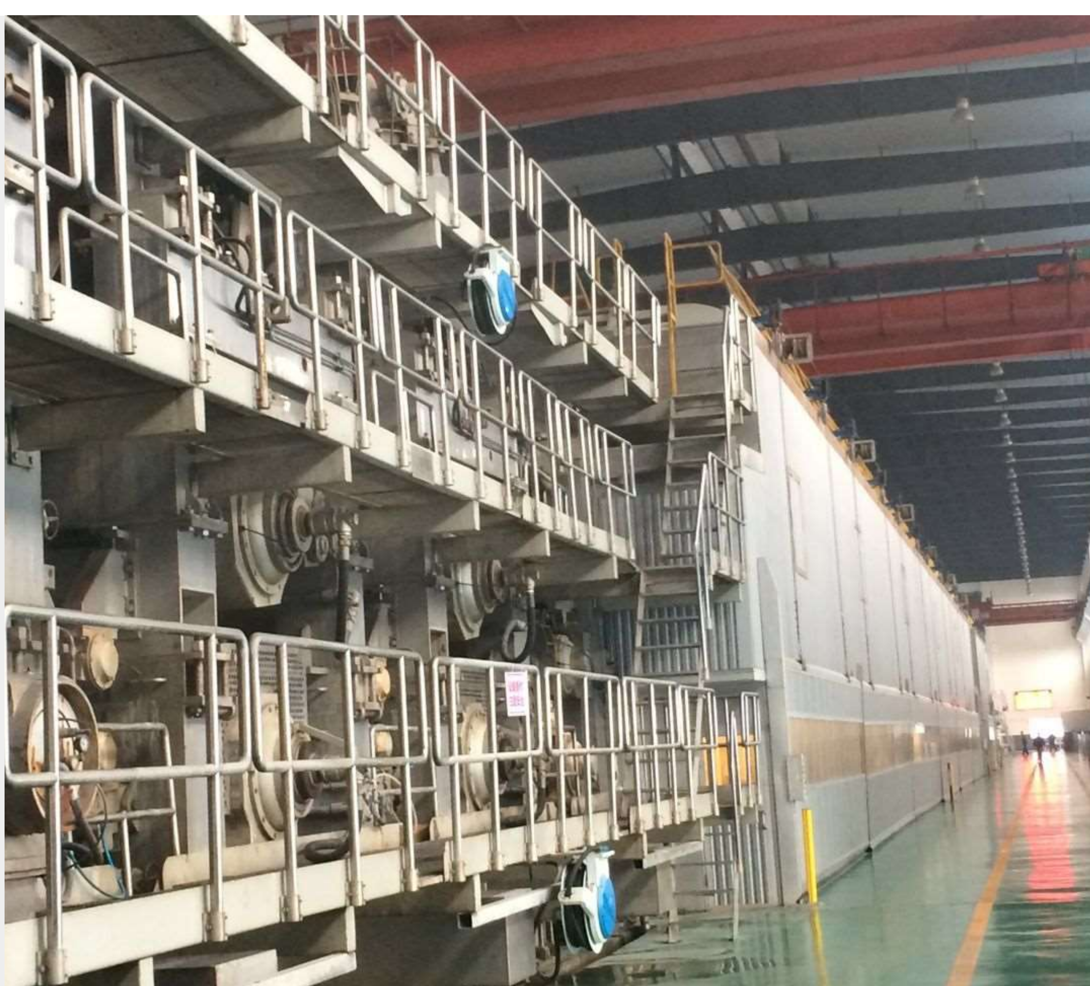
Бумагоделательная машина JUMBO PRESS
